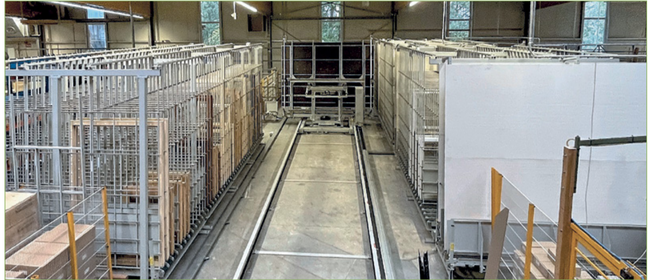
Fährt, neigt und dreht sich: Das Urban-Transportshuttle bei Groß Fenster und Türen in Straßkirchen.
