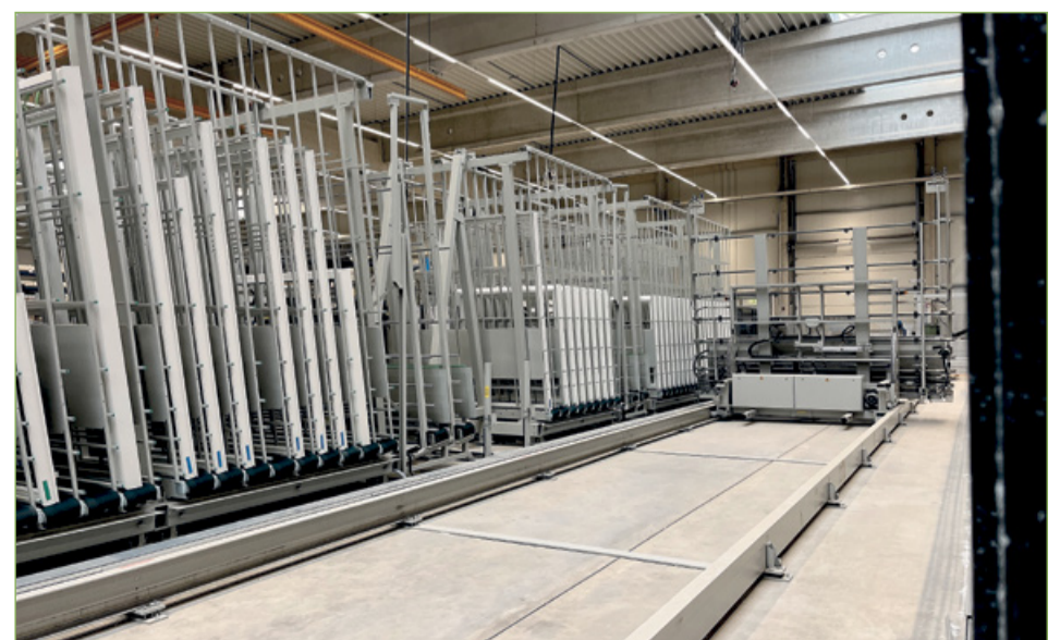
Die Elemente werden dank Urban-Know-how automatisch abgestapelt.
