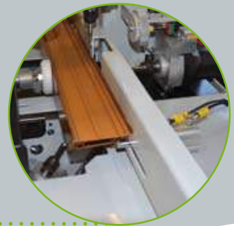
Pneumatische Profilanschläge (links und rechts).
