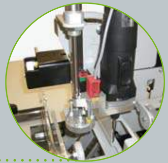
Bohr-/Fräsaggregat oben mit 6-fach Revolveranschlag.
