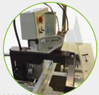
Bohr-/Fräsaggregat oben mit Winkelverstellung +/- 20°.
