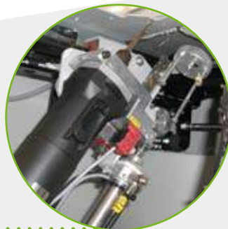
Bohr-/Fräsaggregat von unten mit Winkelverstellung 0-65°
