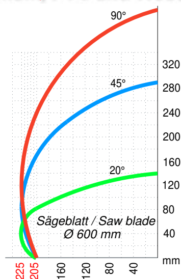
Schnittdiagramm DGL260 Cutting diagram DGL 260
