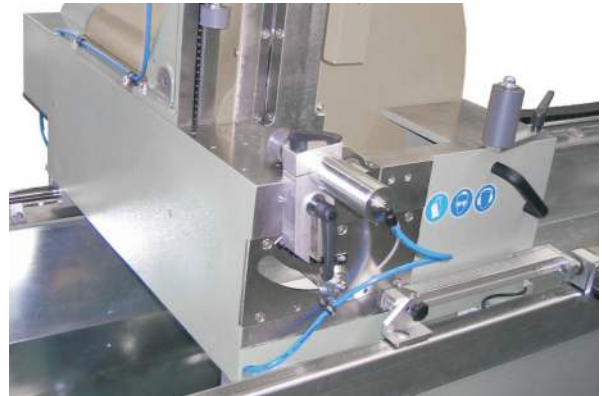
Längeneinstellung über Schnellspannklemmhebel / Length adjusting device
