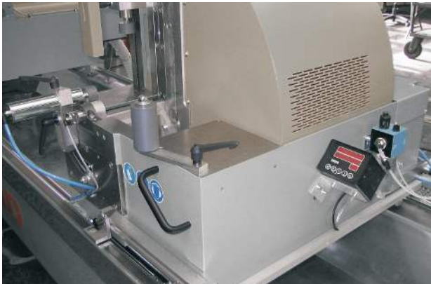
Digitale Längenanzeige mit 30 speicherbaren Korrekturwerten / Digital length display with 30 storable correction values
